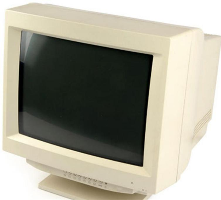
Рисунок 1. ЭЛТ-монитор
